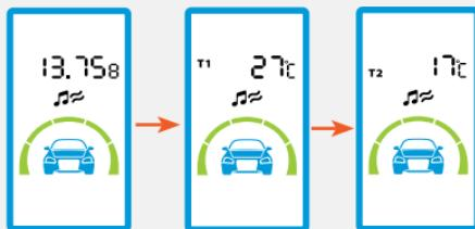
\*Измеряемые значения напряжения АКБ, температуры салона и температуры двигателя носят только информационный характер, по которым можно косвенно судить о измеренных параметрах (StarLine A93 v2, A63 v2 не является измерительным прибором). Контроль температуры двигателя возможен только при подключенном к комплексу датчике температуры двигателя. Датчик температуры двигателя в комплекте только StarLine A93 v2.
